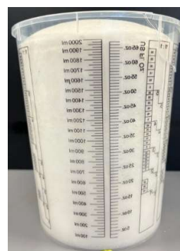
400 gram blir +/- 2200 ml efter 15 minuter = Topptemp. 55 °C
